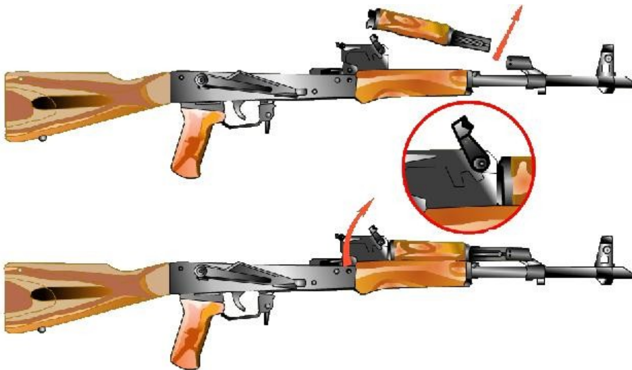
Рис. 9. Отделение газовой трубки со ствольной накладкой
